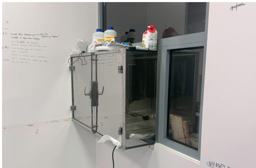
Ryc. 16. Inkubator wykonany z szafy oraz maty grzewczej.
