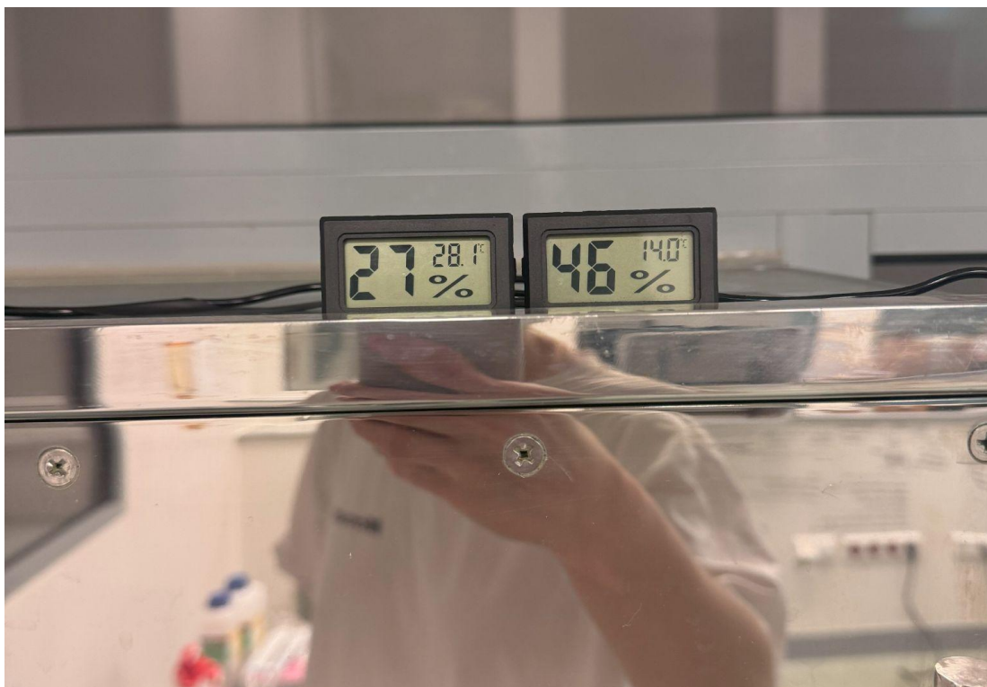
Ryc. 17. Pomiar temperatury i wilgotności w inkubatorze oraz poza nim.
