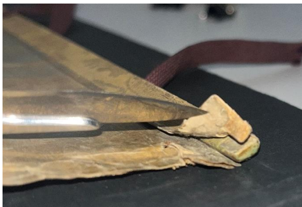
↑ Il. 65. Zbliżenie na montaż rdzenia, przy górnej krawędzi, stan przed konserwacją. Fot. J. Machnik, 2023.
