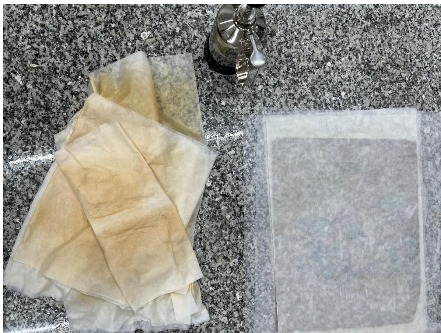
← Il. 146. Fragment zwoju podczas oczyszczania oraz zużyte bibuły filtracyjne. Fot. J. Machnik, 2024.
