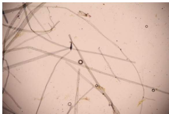
↑ Il. 99, 100. Porównanie fotografii mikroskopowych włókien z warstw papieru nr 5 (po lewej) i nr 6 (po prawej). Obie próbki w odczynniku Graff C, w powiększeniu 200.
