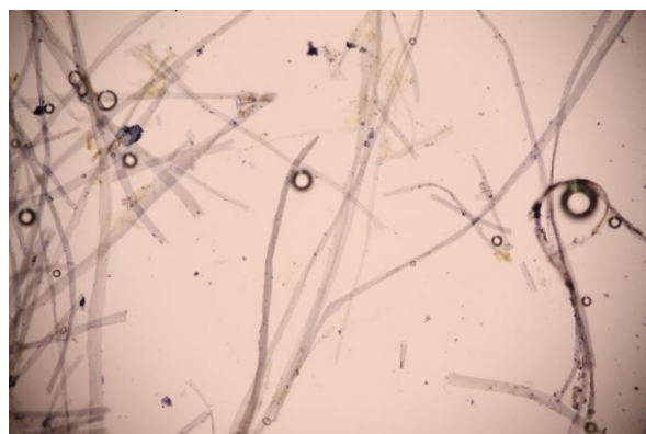
↑ Il. 99, 100. Porównanie fotografii mikroskopowych włókien z warstw papieru nr 5 (po lewej) i nr 6 (po prawej). Obie próbki w odczynniku Graff C, w powiększeniu 200.
