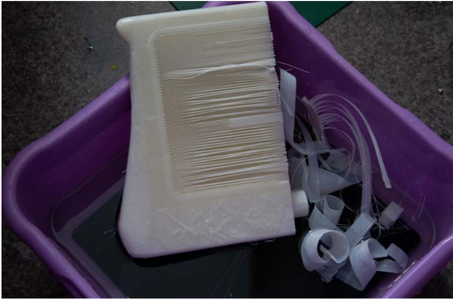
Proces zmywania podpory z PVA w celu uzyskania czystej powierzchni.
