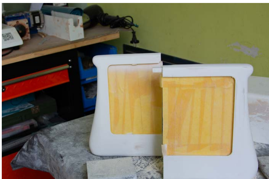
Malowanie elementów podmalówką.
