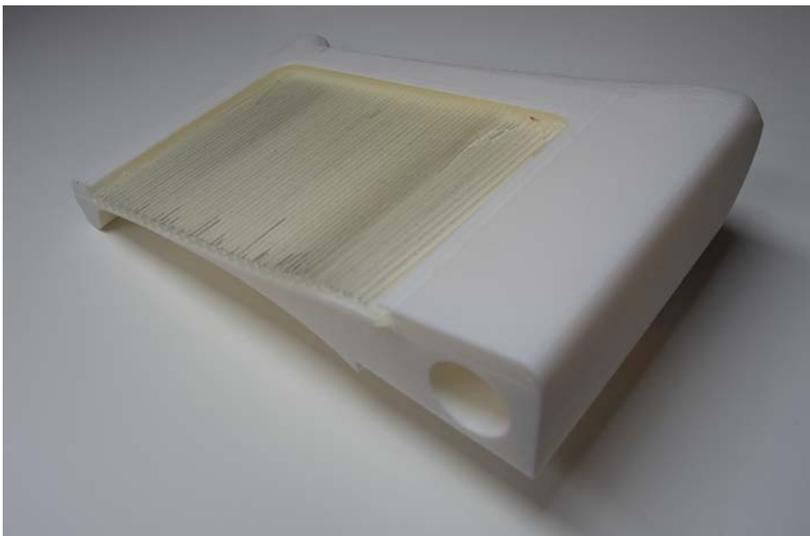
Wydrukowany element z PLA z zastosowaniem podpory z PVA.
