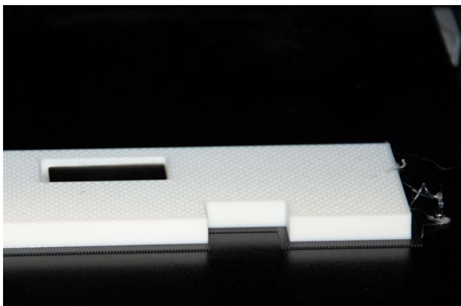
Wstawianie magnesów w trakcie procesu drukowania 3D.
