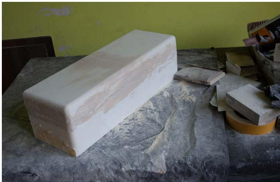
Sklejenie 4 elementów w całość i szpachlowanie.
