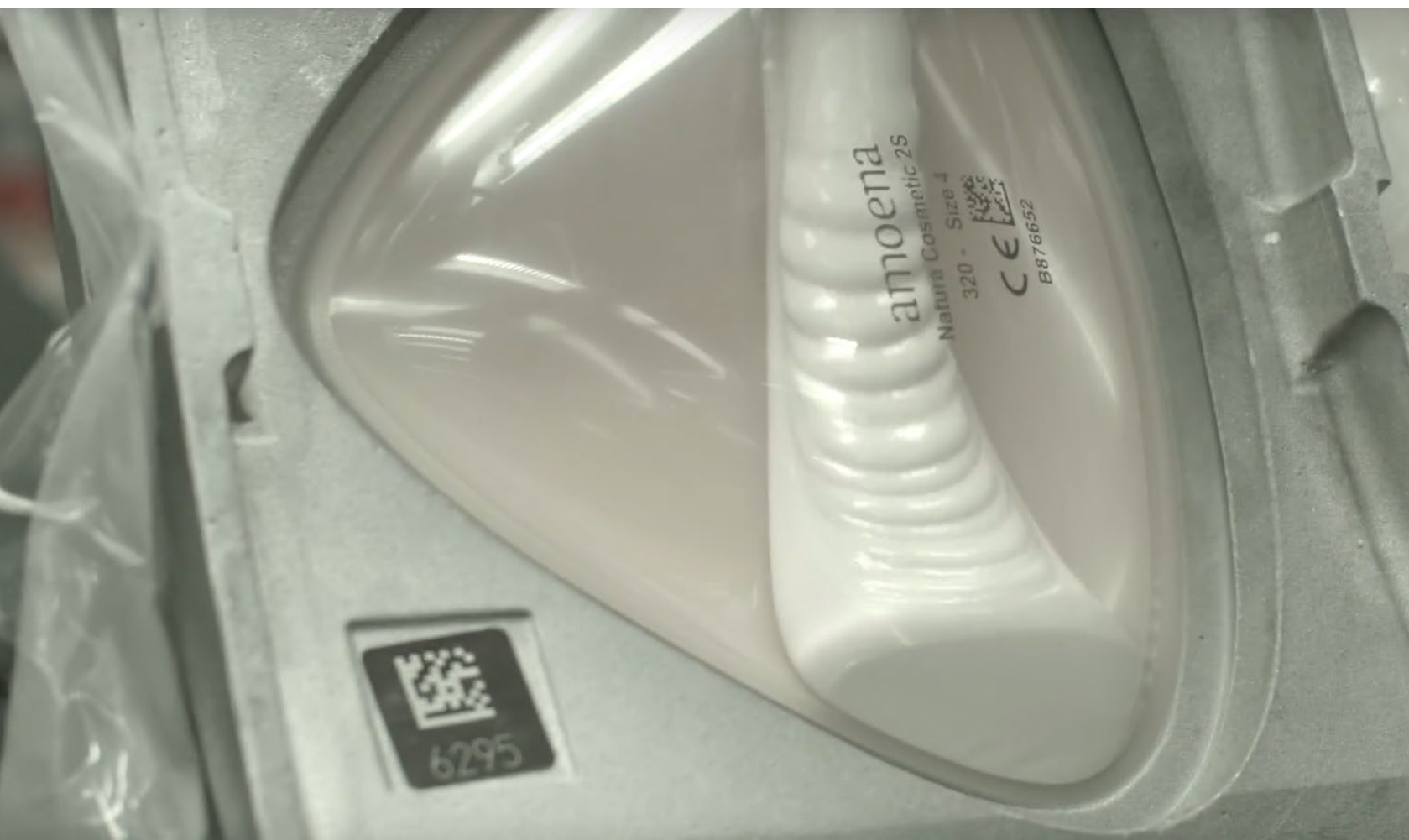
ilustracja 14. kadr z filmu przedstawia- jącego proces produkcji wkładek firmy Amoena, moment wypełniania formy silikonem
