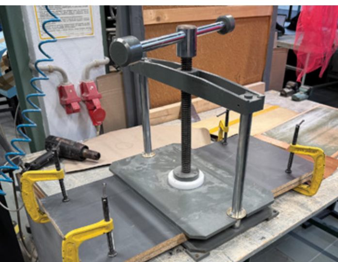
> ilustracja 58 – proces termoformowania > ilustracja 59 – rezultat gięcia relingów
