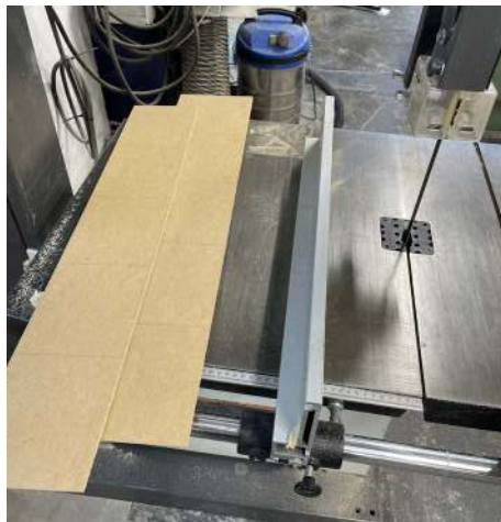
ilustracja 54 cięcie płydy HDF
