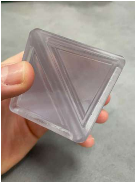
ilustracja 151 próbka wydruku w technologii SLA w firmie CADXPART
