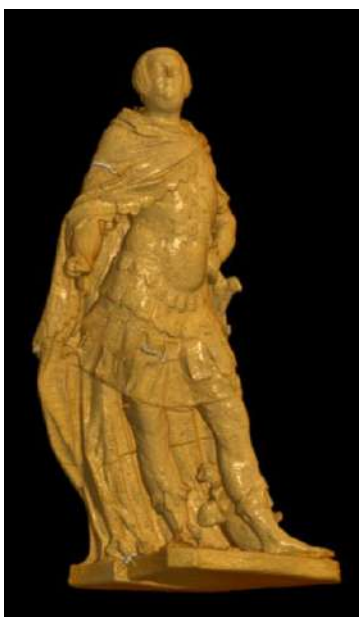
Ilustracja 84: Tomografia komputerowa statuetki Augusta III Sasa. Widok od lewego boku. Widoczne miejsca podziałów w poszczególnych miejscach na statuetce. Ilustracja 85: Tomografia komputerowa statuetki Augusta III Sasa. Widok od prawego boku. Widoczne miejsca podziałów w poszczególnych miejscach na statuetce. Ilustracja 86: Tomografia komputerowa statuetki Augusta III Sasa. Widok od tyłu. Widoczne miejsca podziałów w poszczególnych miejscach na statuetce.
