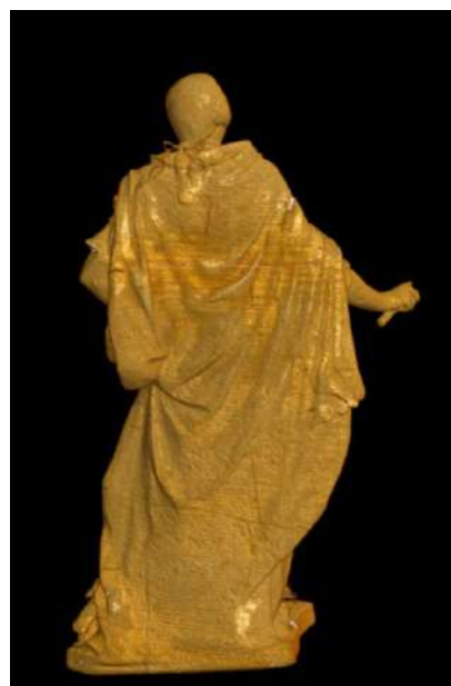
Ilustracja 84: Tomografia komputerowa statuetki Augusta III Sasa. Widok od lewego boku. Widoczne miejsca podziałów w poszczególnych miejscach na statuetce. Ilustracja 85: Tomografia komputerowa statuetki Augusta III Sasa. Widok od prawego boku. Widoczne miejsca podziałów w poszczególnych miejscach na statuetce. Ilustracja 86: Tomografia komputerowa statuetki Augusta III Sasa. Widok od tyłu. Widoczne miejsca podziałów w poszczególnych miejscach na statuetce.
