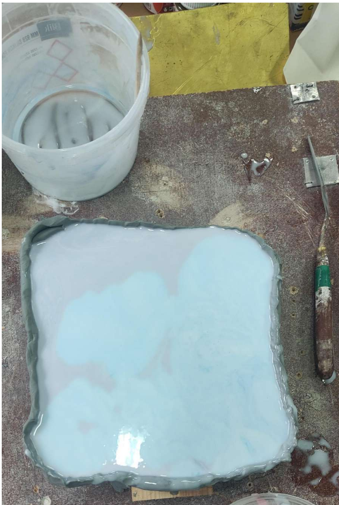
Fot nr 99. Forma silikonowa utworzona na odcisku negatywu porcelanowej podstawy. Autor fot. Jagoda Adamek 2024.
