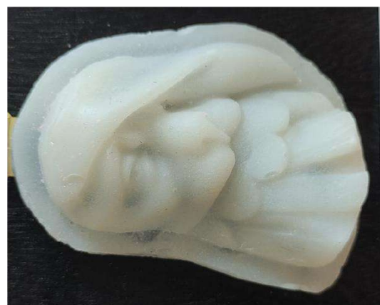
Fot. nr. 53, 54, 55, 56, 57, 58. Próby uzupełnień porcelany: a) Hxtal Nyl-1 z krzemionką koloidalną jako wypełniacz; b) Hxtal Nyl-1 z mikrobalonami szklanymi jako wypełniacz, z dodatkową warstwą żywicy Hxtal Nyl-1 jako imitacja szkliwa; c) Axson S.C. 258, farby Pebeo Ceramic jako imitacja farb naszkliwnych; d) Milliput Supreme White; e) Hxtal Nyl-1 z mikrobalonami szklanymi jako wypełniacz; f) Hxtal Nyl-1 z mikrobalonami szklanymi jako wypełniacz, farby Pebeo Ceramic jako imitacja farb naszkliwnych. Autor fot. Jagoda Adamek 2024.
