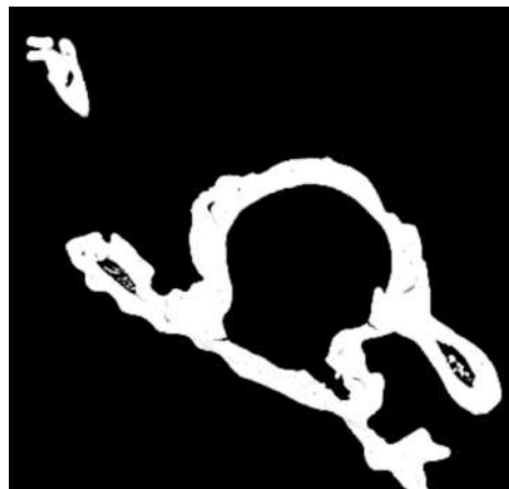
Ilustracja 82: Tomografia komputerowa statuetki Augusta III Sasa. Przekrój umiejscowiony na wysokości rąk postaci, widok od góry. Widoczna stłuczka porcelanowa w pustych przestrzeniach oraz wewnętrzne spękania statuetki.
