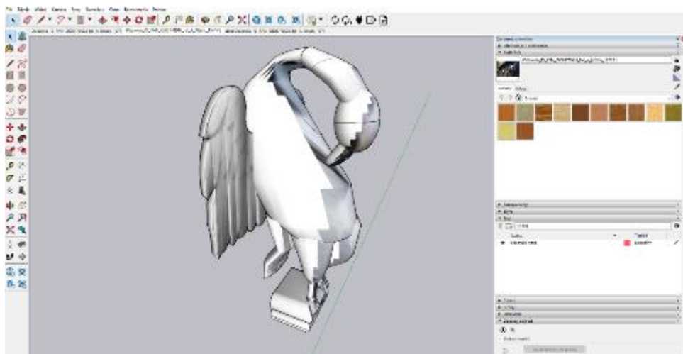
Il. 152 Model rzeźby pelikana z zewnętrznej ściany kościoła w Olszówce, z naniesioną teksturą na połowę obiektu.
