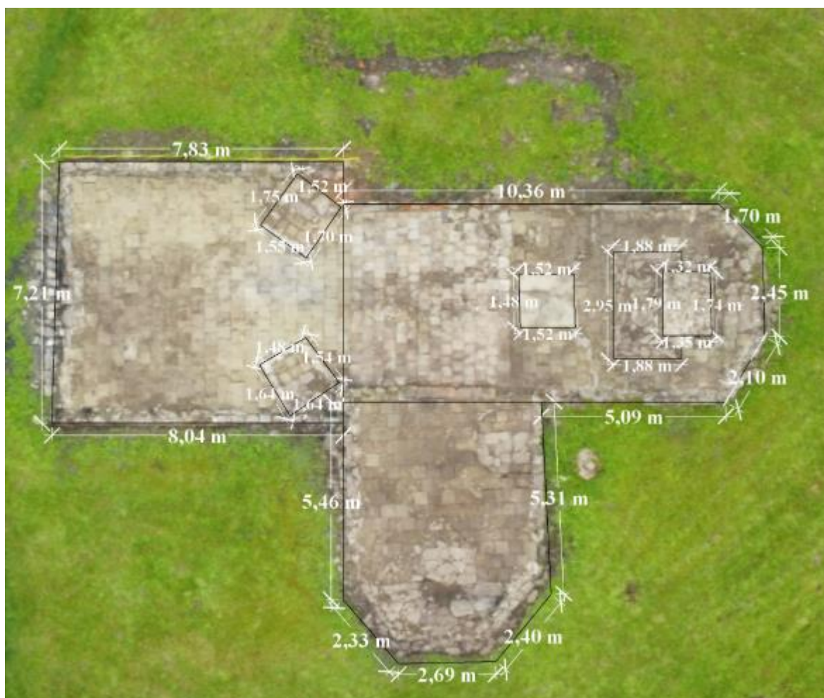
Il. 11 Kamienna posadzka kościoła pw. Św. Jana Chrzciciela w Olszówce, po odsłonięciu, z naniesionymi pomiarami obiektu na fotografię lotniczą.
