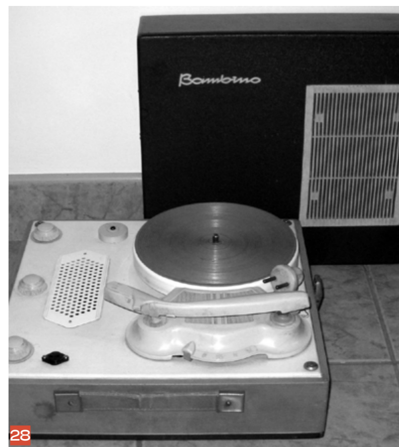
Bambino – polski monofoniczny gramofon lampowy, produkowany przez zakłady ŁZR Fonica w Łodzi od roku 1963.
