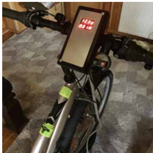
il. 4. Prądnica rowerowa – wyświetlacz (źródło własne)
