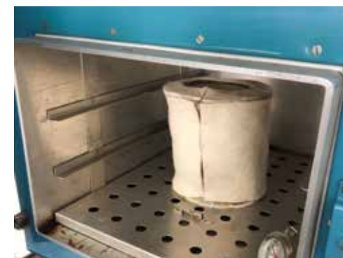
il. 28. Utwardzanie silikonu w 200 °C
