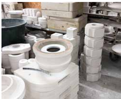
il. 80. Suszenie odlewu i kontrolowanie zachowania się okręgu (źródło własne)
