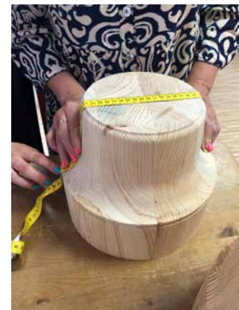
il. 93. Mierzenie form dla wykonania odpowiedniego stożka filcowego
