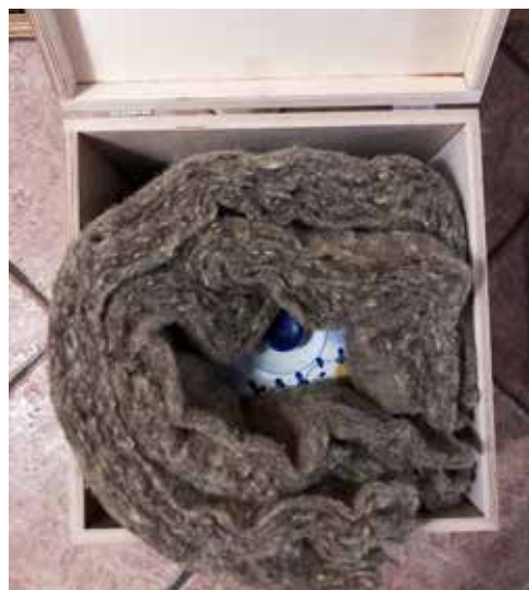
il. 17. Zdjęcie wnętrza skonstruowanej kuchenki (źródło własne)
