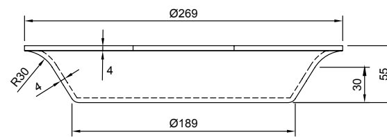
wymiary wewnętrznej ścianki pokrywki
