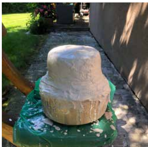
il. 90. Odlewanie w gipsie prototypu filcowego
