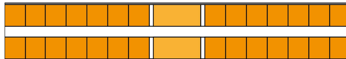
34. Rozstawienie miejsc siedzących w wagonie 186A Newag. Autorskie rozstawienie: 16 rzędów po 4 fotele na rząd
