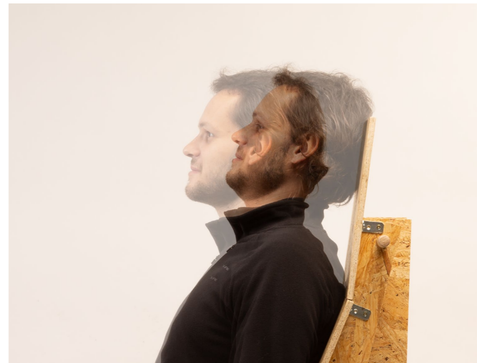
52. Mockup w skali 1:1, odchylenie głowy mężczyzny (193 cm) przy kącie odchylenia zagłówka.
