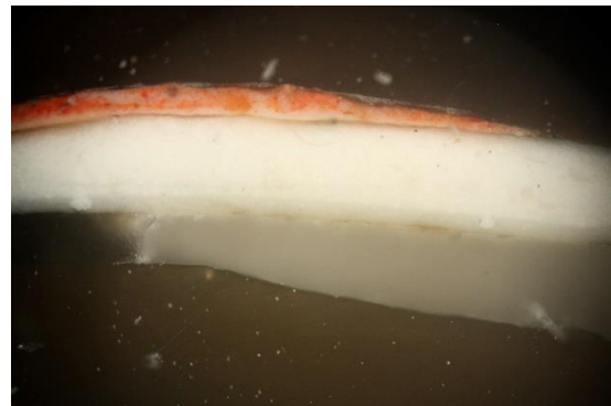
Il. 27 Zdjęcia mikroskopowe przekrojów poprzecznych próbek pobranych z warstwy czerwieni z marmoryzacji. Fot. Dr M. Goryl, 2023 r.
