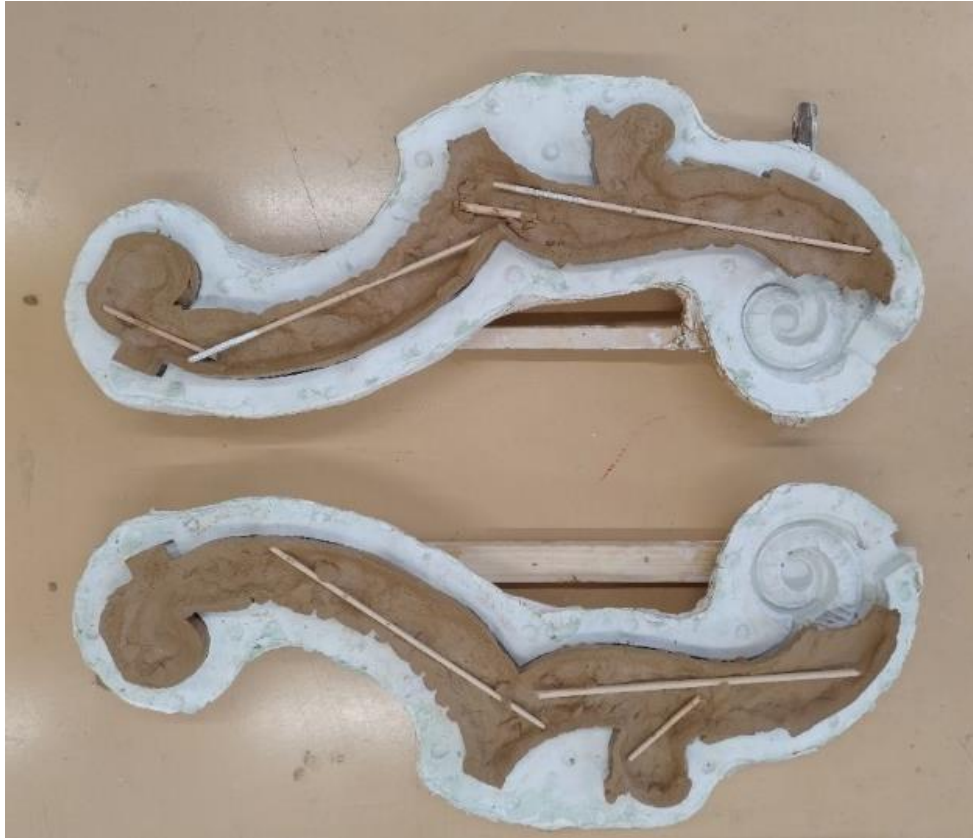
Il. 68. Po utwardzeniu silikonu, rozłożono połówki formy. Następnie rozpoczęto proces tworzenia docelowych elementów brakujących konsol z masy modelarskiej Axson SC - 258, przez wciskanie substancji do formy silikonowej, usztywnionej w płaszczu gipsowym. Fot. O. Gabryś, 2023 r.
