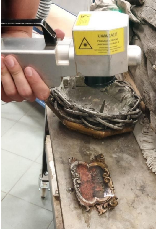
II. 50. Proces odcyszczania kartusza metodą ablacji laserowej. Fot. O. Gabryś, 2023 r.
