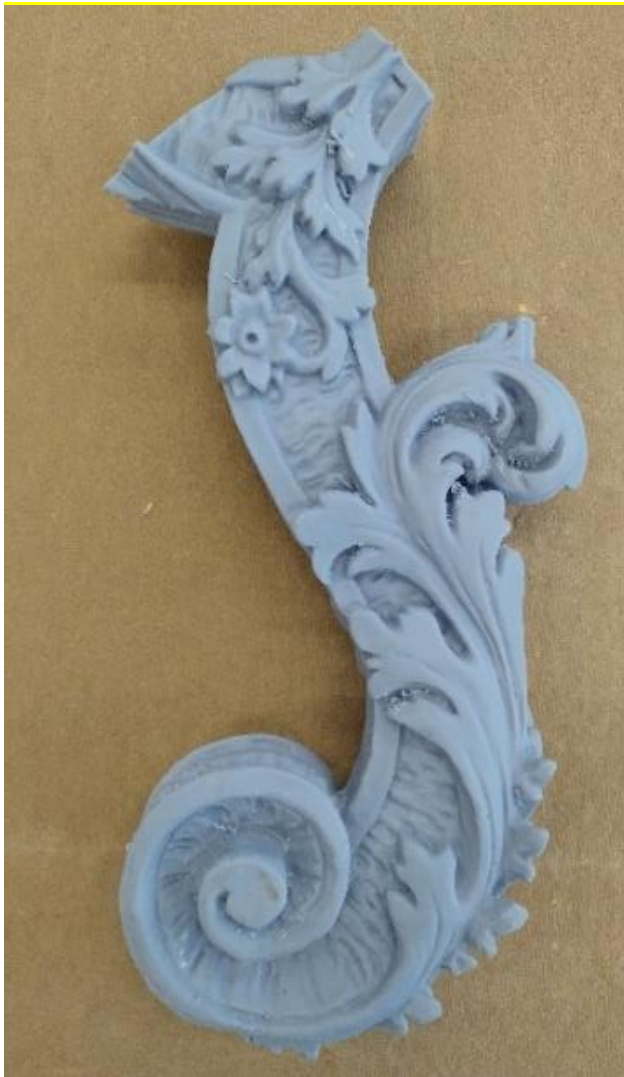
Il. 62. Fragment konsoli wydrukowanej z żywicy 3D Printing UV Sensitive Resin. Fot. O. Gabryś, 2023 r.
