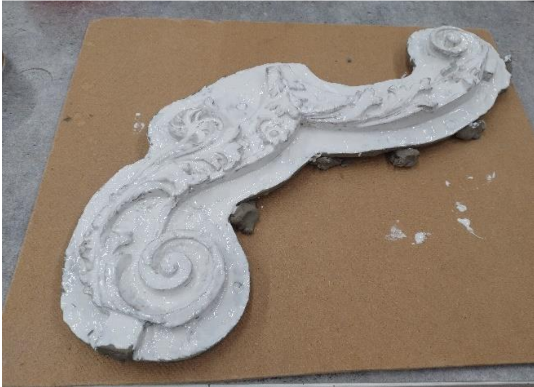
Il. 66. Proces nakładania silikonu kauczukowego. Fot. O. Gabryś, 2023 r.
