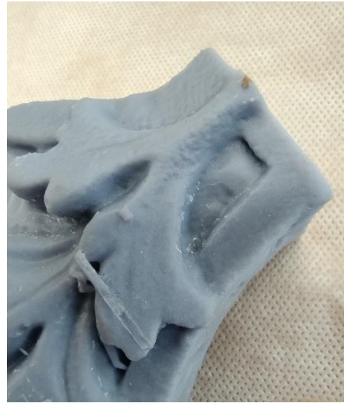
Il. 61. Detal, fragment wydrukowanej konsoli z żywicy 3D Printing UV Sensitive Resin. Widoczne chropowatości na powierzchni materiału spowodowane odbiciem światła na złocie na oryginalnym, skanowanym elemencie. Fot. O. Gabryś, 2023 r.
