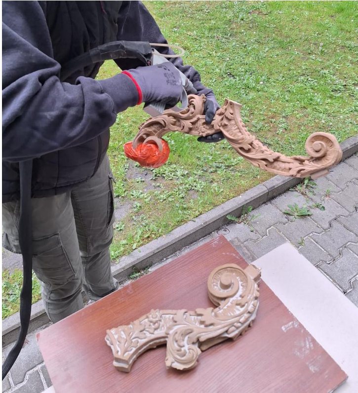
Il. 74. Proces modyfikacji powierzchni odcisków z masy Axson SC - 258 metodą strumieniowo ścierną. Fot. W. Woźniak, 2024 r.
