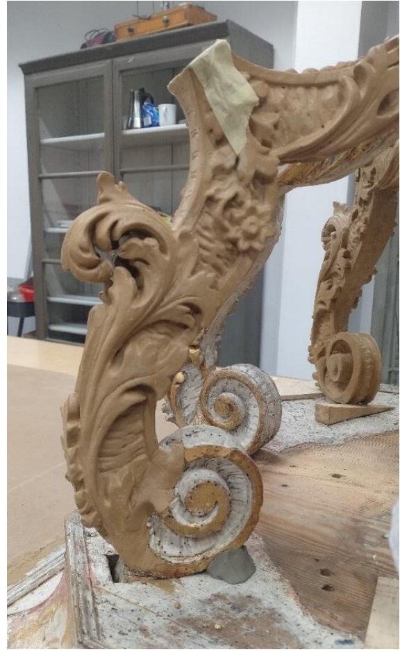
Il. 73. Proces łączenia oryginalnych części konsoli z nowopowstałymi. Fot. O. Gabryś, 2024 r.
