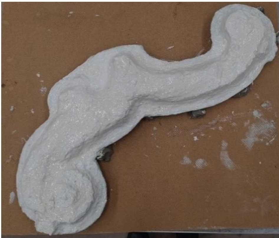
Il. 67. Po nałożeniu i utwardzeniu odpowiednio grubej warstwy silikonu na pierwszą część konsoli, odwrócono element aby nałożyć substancję na drugą połowę. Fot. O. Gabryś, 2023 r.
